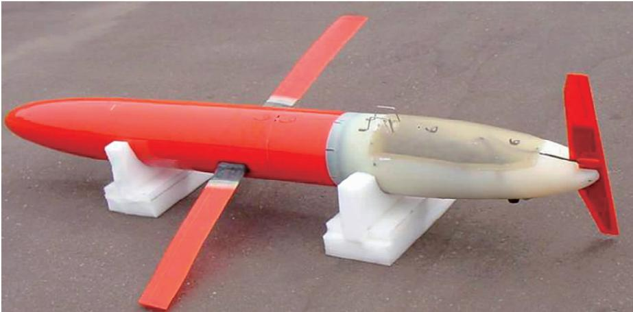
图2 SIO Spray 水下滑翔机
